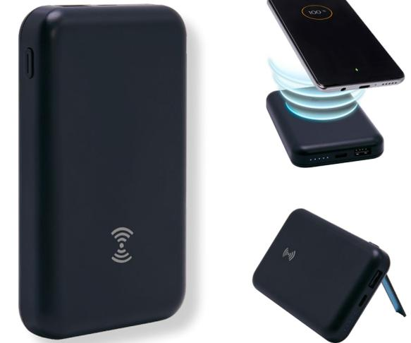
Batería auxiliar para smartphone, capacidad 5,000 mAh con carga inalámbrica y tecnología de imanes que se fija de manera automática y segura en la posición más óptima para iniciar la carga. Compatible con dispositivos iOS recientes. Display indicador de batería. Puerto tipo C, USB y lightning (8 pines). Soporte en la parte trasera. LED que indica nivel de carga. Potencia de carga 5W. Incluye cable cargador compatible con USB y tipo C.
